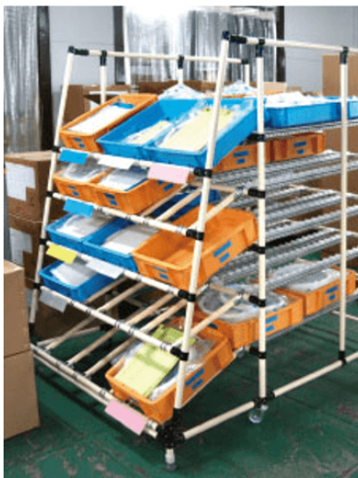
ピッキングフローラック
